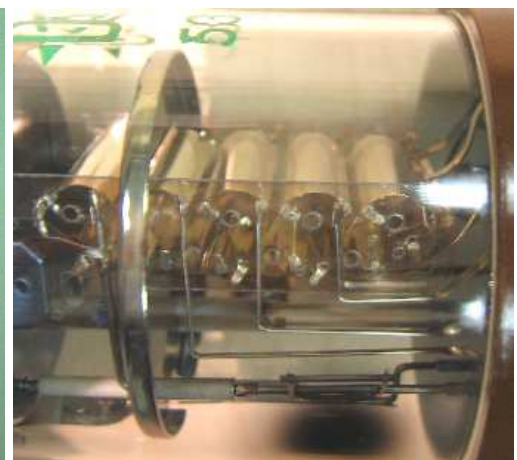
Imágenes de un Tubo foto-multiplicador modelo RCA C31034A-02 , a la derecha detalle de los dínodos .
